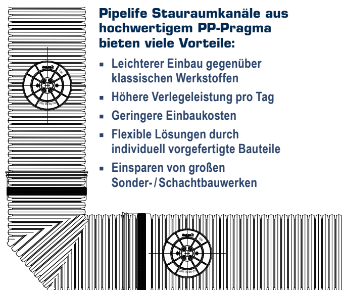
PP-Pragma Stauraumkanal: Draufsicht und seitliche Ansicht
