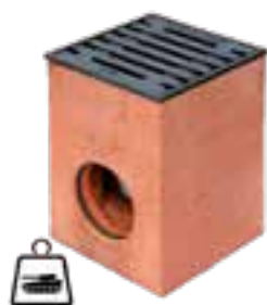
SKS001 – einteilige Hofabläufe Kl. E 600 kN, KG Muffe 150, Maße: 30 x 30 x 43 cm
