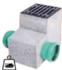
SAT002 – Spezialabläufe mit Trennsystem, Belastungsklasse E 600 kN, Maße: 30 x 30 x 44,5 cm, Wasser/Silage
