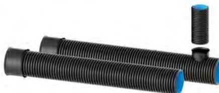
Das Zubehörprogramm umfasst Dichtringe, Endkappen, Bögen und Aufsetzrohre für Inspektionsöffnungen. Mit den DN/OD 500 Schachtaufsetzrohren ist eine einfache Wartung des Stauraumkanals mittels gängiger Kanal-, Spül- und Inspektionstechnik jederzeit möglich. Die Spülfestigkeit der Verbundrohre ist gemäß DIN 19523 nachgewiesen.
